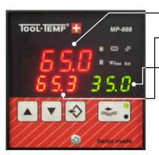
Solltemperatur (gewünschte Temperatur) Verstellung der Solltemperatur in <sup>1</sup>/<sub>10</sub>°-Schritten
